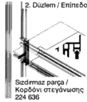
Resim 1. 72: Düşey profilin içten dışa doğru montajı
