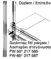
Resim 1. 72: Düşey profilin içten dışa doğru montajı
