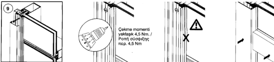
Resim 2.17: Çıta tutucuların vidalanması ve profillerin montajı
