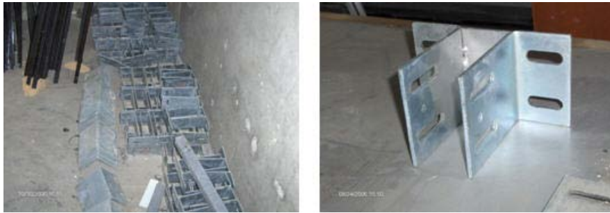
Resim1.39: Projeye göre hazırlanmış ankraj çeşitleri
