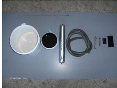
Resim 1. 69: Cam takozu, sosis fitil, sızdırmazlık yapıştırıcısı, a+b karışımı kauçuk esası
